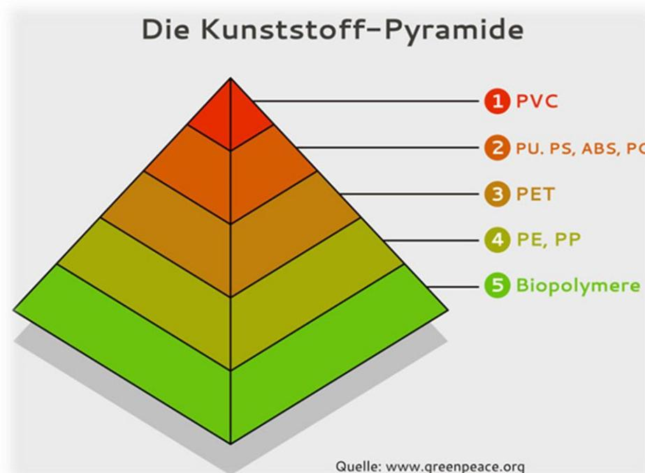
Ausgangsmaterial für die Produktion von Kunststoffen ist immer Rohöl. Der Kunststoff, der daraus gemacht wird kann die Umwelt mehr oder weniger belasten. Das hängt vom Aufwand bei Produktion und Recycling sowie der Gefährdung durch austretende Stoffe im Lebenszyklus ab. Die Kunststoffpyramide von Greenpeace hilft bei der Einschätzung. Polypropylen (PP) zählt nach den Biopolymeren zum verträglichsten Kunststoff.
