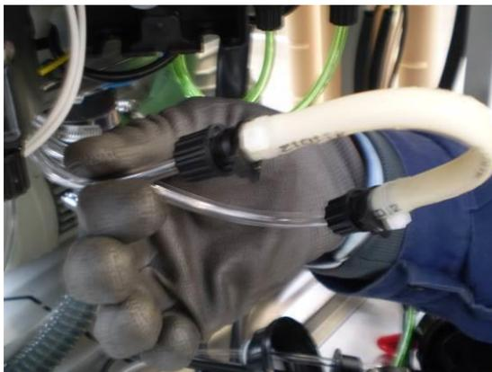
6. Die Schlauchklemmen lockern und die Fuehrungsschlaeuhe des Produktes von den Membrananschluesse abtrennen.
