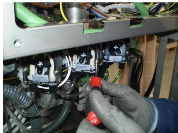
3. Den Membranschlauch unter der Dosierpumpe herausnehmen.
