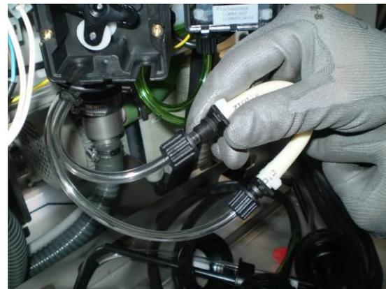
7. Den Membranschlauch mit einem anderen Schlauch des gleichen Types tauschen (siehe Ersatzteilliste des Lieferantes).
